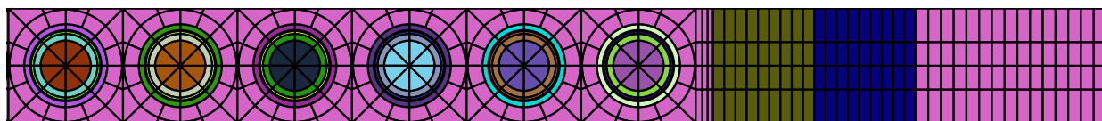
Figure 2.8 Découpe d'une traverse de réflecteur avec six cellules de combustible
