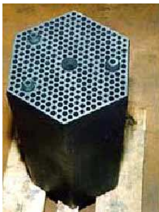
FIGURE 2.3 Élément de combustible : Bloc de graphite
